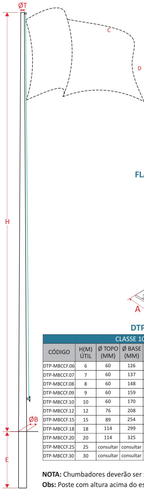
O Mastro para Bandeira é fabricado em chapa de aço SAE 1010/1020 dobrada em prensa no formato de cone de seção circular contínuo ou cone de seção poligonal, de 8, 12 e 16 lados com solda longitudinal por processo automático. O diferencial na sua característica construtiva está na estética, maior resistência mecânica, mais leve e menor área de arraste em relação a força do vento.
